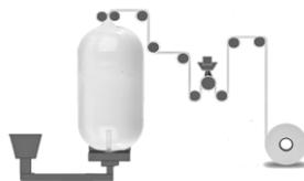
*Ilustración 15: Extrusión vertical en globo para la fabricación de láminas plásticas*
