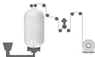
Ilustración 14: Extrusión vertical en globo para la fabricación de láminas plásticas.
